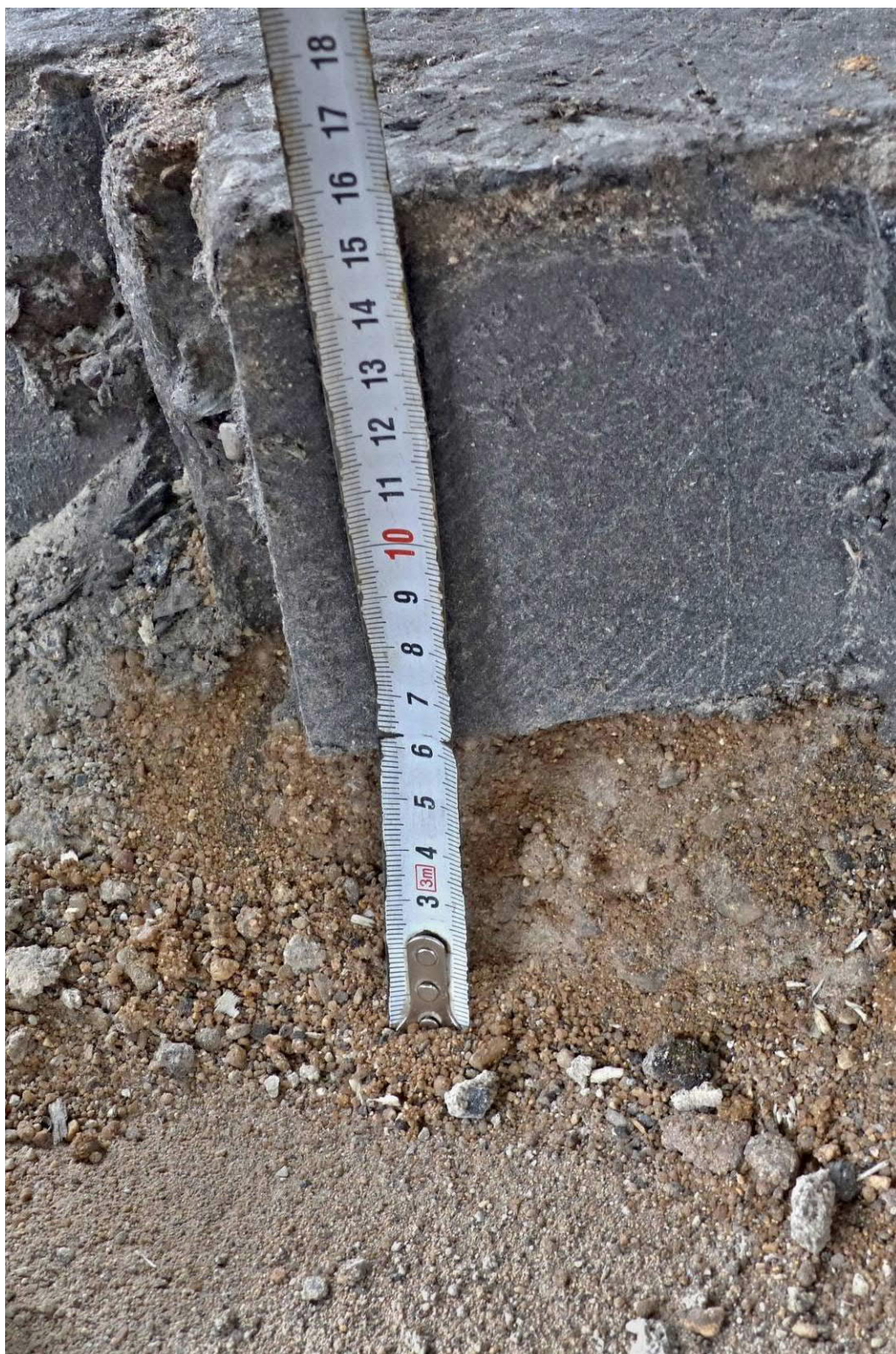
Foto č. 90 Měření tloušťky pískového podsypu kopaná sonda P1 dřevěné špalíky – svařovna
