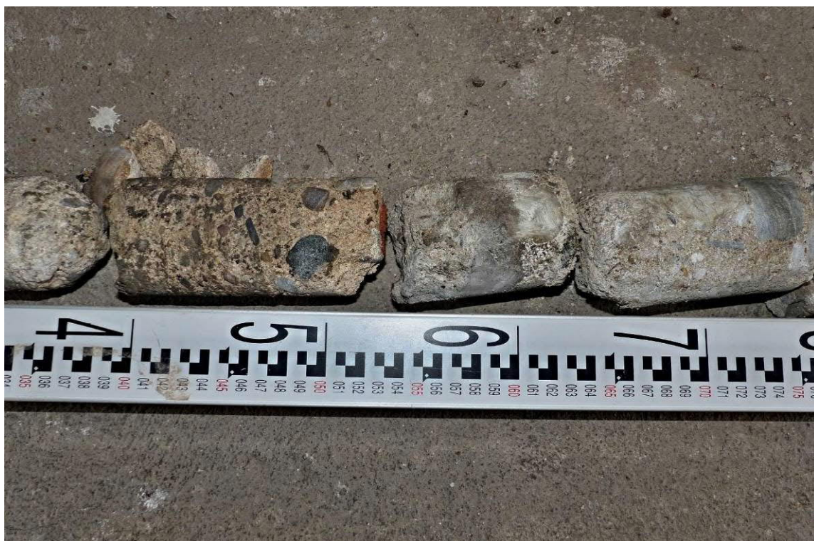
Foto č. 52 Dokumentace vrtného jádra vrtu S2 - dl. 1,84 m pod základy střední nosné zdi
