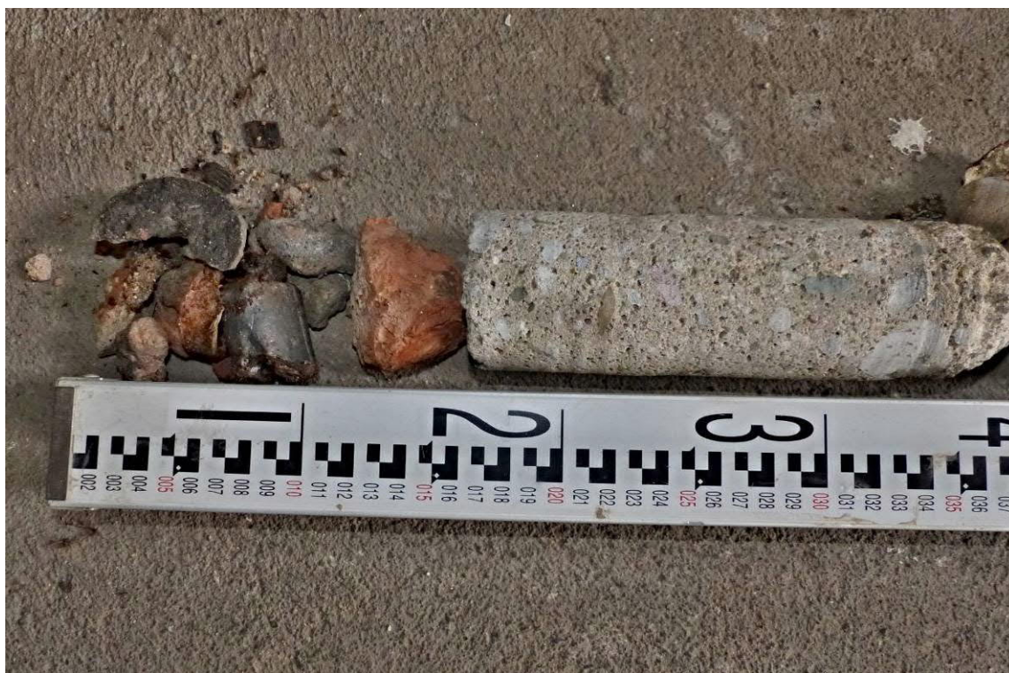
Foto č. 51 Dokumentace vrtného jádra vrtu S2 - dl. 1,84 m pod základy střední nosné zdi
