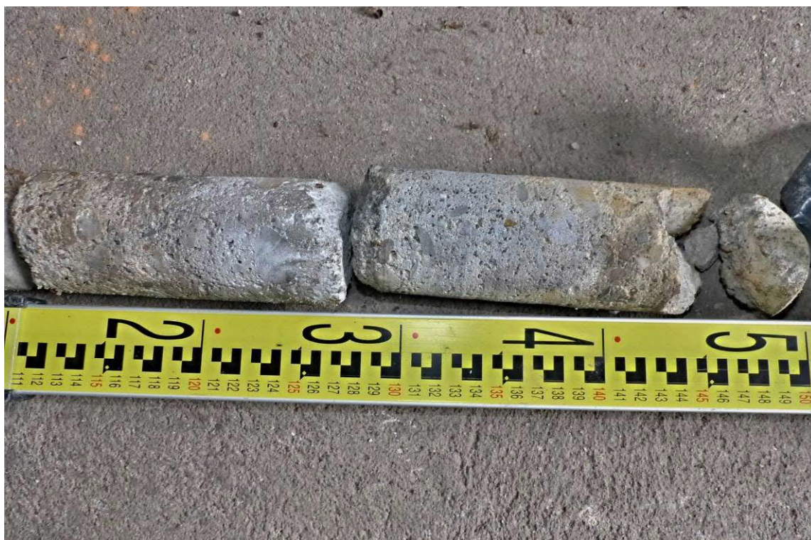
Foto č. 54 Dokumentace vrtného jádra vrtu S2 - dl. 1,84 m pod základy střední nosné zdi
