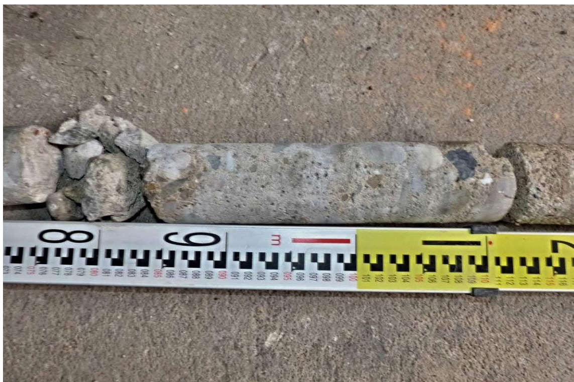
Foto č. 53 Dokumentace vrtného jádra vrtu S2 - dl. 1,84 m pod základy střední nosné zdi
